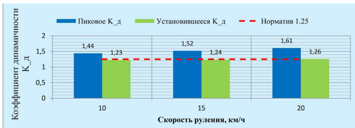
Рис. 8. Гистограмма сопоставления пикового и установившегося K_d с нормативом K_d = 1,25 для трех скоростей при h = 6 мм: норматив превышает только пиковыми значениями, тогда как установившиеся значения остаются ниже норматива (при v = 10 км/ч) или незначительно превышают его (1,26 при v = 20 км/ч)
