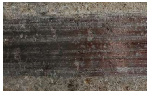
Рис. 4. Реализация процесса термометаллоплакирования: а — поверхность колеса до металлоплакирования; б — поверхность колеса после термометаллоплакирования смесью мягких металлов
