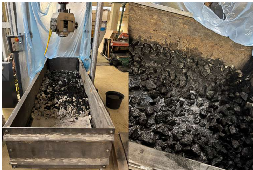
Рис. 3. Послойная отсыпка загрязненного щебня с увлажнением
