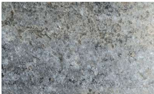
Рис. 4. Реализация процесса термометаллоплакирования: а — поверхность колеса до металлоплакирования; б — поверхность колеса после термометаллоплакирования смесью мягких металлов
