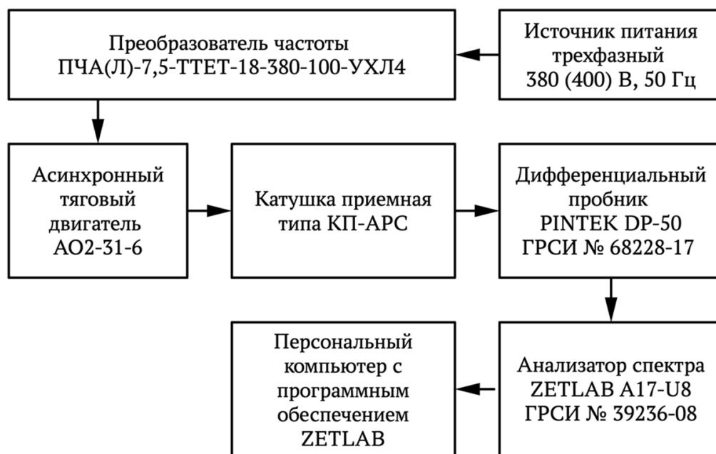
Рис. 1. Структурная схема испытательного стенда для изучения влияния внешних полей
