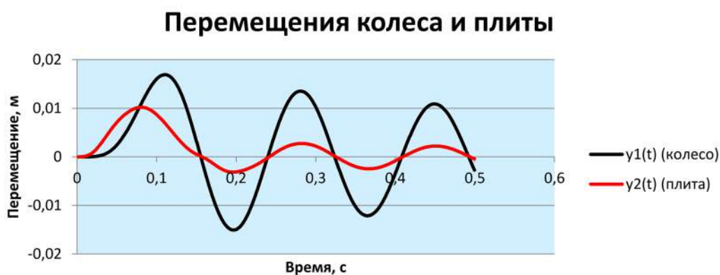
Рис. 5. Перемещения колеса y_1(t) и плиты y_2(t) при проезде А380 по неровности ( h = 10 мм, v = 15 км/ч): положительные значения соответствуют подъёму от статического положения; разность кривых — деформация шины; видно опережение колеса (пик при t \approx 0,023 с) и последующие затухающие колебания.
