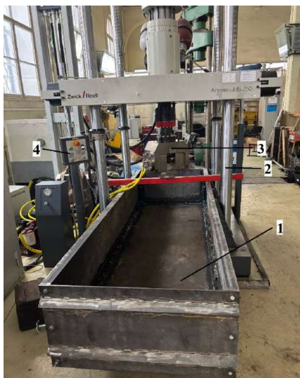
Рис. 2. Стендовая установка (пульсатор) Amsler HB 250: 1 — металлический ящик размером 2700 \times 1000 \times 500 мм, в котором устраивается модель балластной призмы; 2 — рама; 3 — нагрузочное устройство; 4 — пульт управления
