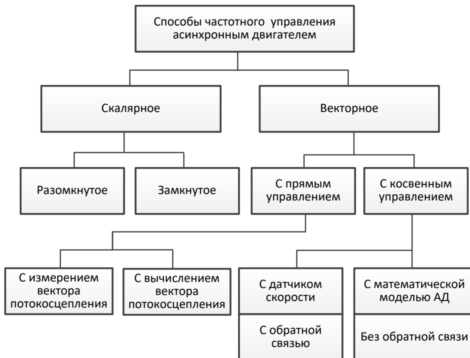
Рис. 1. Способы частотного управления асинхронным двигателем
