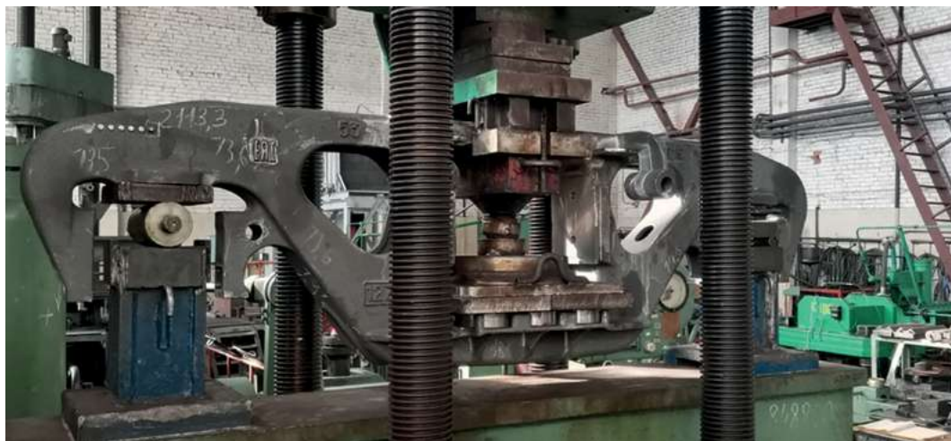
Рис. 2. Общий вид усталостных испытаний рамы боковой тележки модели 18-9891 методом Локати на испытательной машине (автор фото — С. О. Комиченко)
