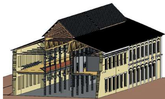
Рис. 3. Созданная на основе трехмерного лазерного сканирования 3D-модель здания токарно-механической мастерской [7]
