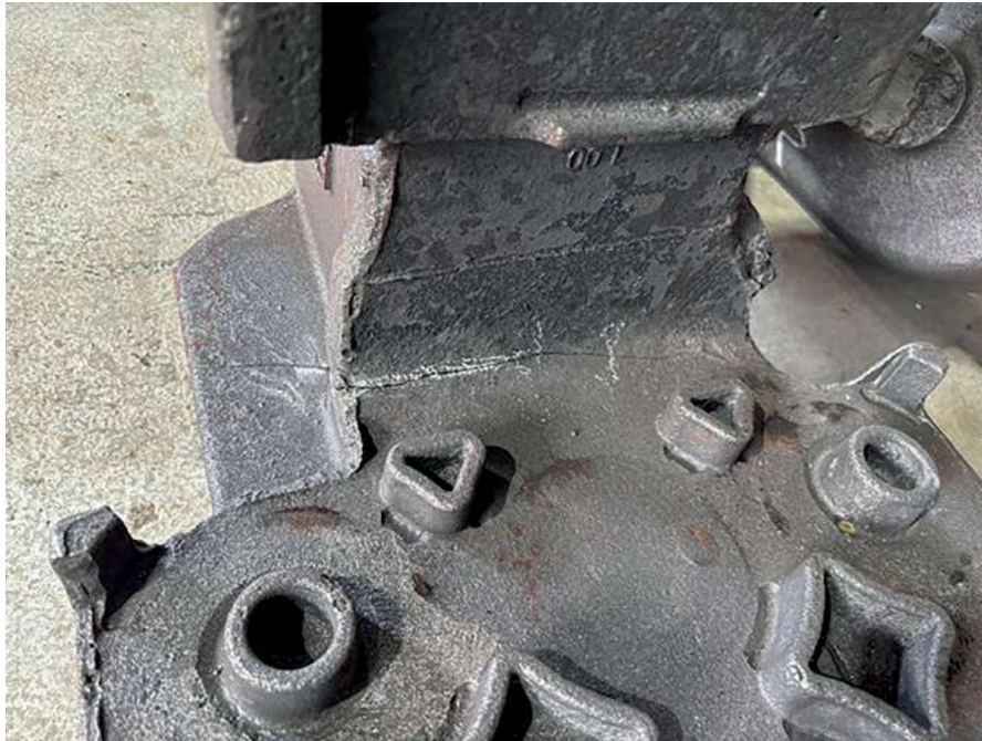
Рис. 5. Характер и зона усталостного разрушения боковой рамы 20162 тележки модели 18-9891 (черт. № 9891.01.00.001) (автор фото — С. О. Комиченко)
