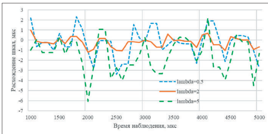
Рис. 6. Расхождение локальных шкал времени ведущих и ведомых часов по результатам экспериментов 4, 5, 6
