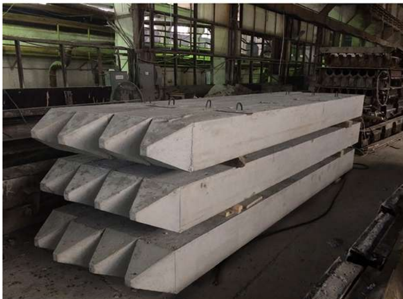
Рис. 1. Сваи железобетонные квадратного сечения. Изготовитель — акционерное общество «ТЖБИ-4» (фотография предоставлена автором)
