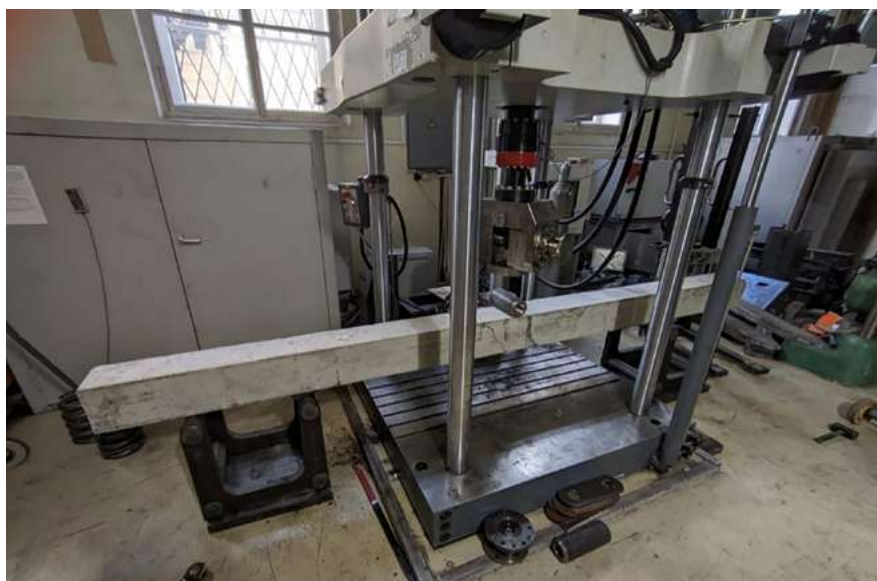
Рис. 9. Стенд для испытаний свай на трехточечный изгиб
